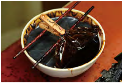
それぞれの職人が自ら精製する上塗り漆。川原さんは3～4種類の漆を混ぜて作る。
