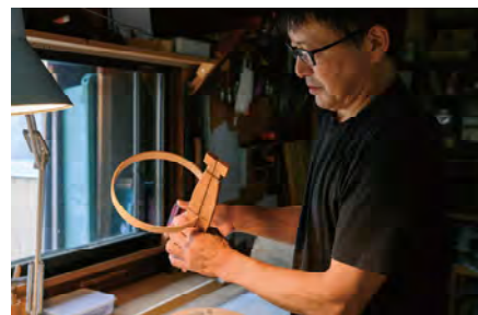
継ぎ目を「ツカミ」という道具で押さえて形を整える。
