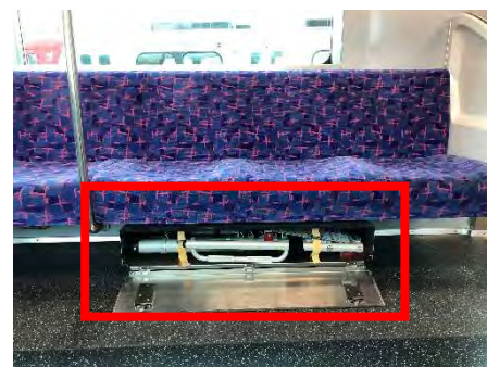
非常脱出伸縮はしごの車内配置
