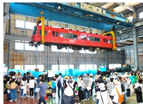
36トンクレーン電車つりあげ作業
