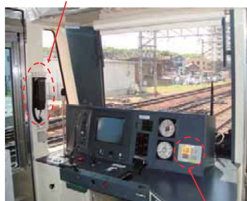
防護無線のボタン
