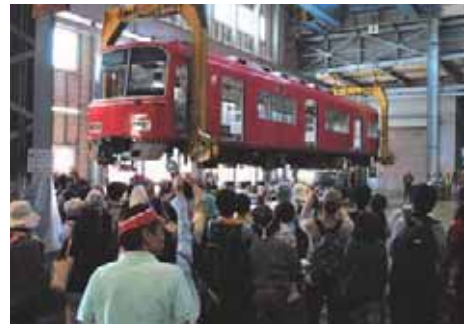
クレーンによる電車のつりあげ作業
