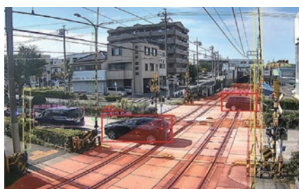
AI画像解析装置を活用した踏切監視システム
