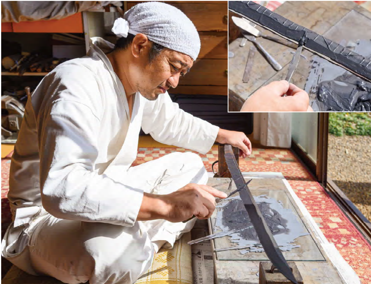
線を引くように焼きの入り位置を決め、小山が連なるような刃文をイメージしながら焼刃土を塗る「土置き」。火を使わない工程でも、気を抜かない作業は続く。
