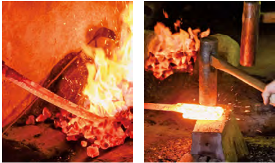
焼き入れは刀身が800℃になる色を判断するため暗い中で行う。高温すぎると刃が割れてしまうことも。 刀匠が小鋸で出す合図に合わせ、弟子は大鋸を打つ。「相槌を打つ」の語源になっているのだそう。
