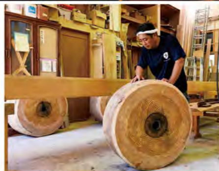
ゴマと呼ばれる車輪はひとつ200kgもの重量がある。後ろの長い木材は、山車を操る楯棒を新調するためのもの。
