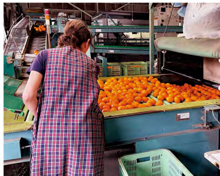
自動化された出荷レーン。傷などは目視で確認し、サイズ分けされて箱詰め工程へと進む。途中には、糖度をチェックする機械も。
