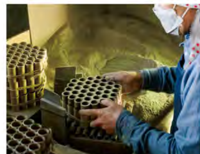
火薬や金属などを混ぜた粉状の星を、紙パイプに詰める。
