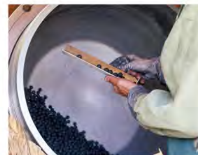
星を作る作業。回転する釜に材料を少しずつ加えていき、粒を大きくしていく。
