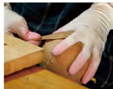
合わせた玉の外側にクラフト紙を貼り重ねる。花火が大きく丸く開く秘訣がこの工程。
