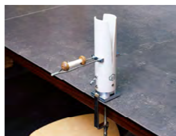
大須賀さん開発の「くり台」と呼ばれる道具。パーツを付け替えれば、1台でさまざまな技法に対応できる。
