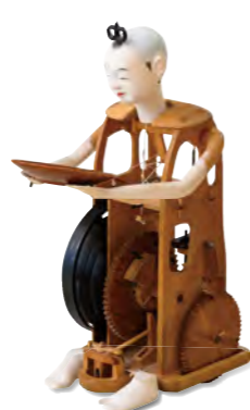
「茶運び人形」は和時計の原理を応用した座敷からくり。腕がスイッチになっている。
