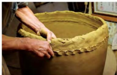
積み重ねた部分は強度に欠けるため、さらに細い粘土の棒を貼り付けて補強していく。
