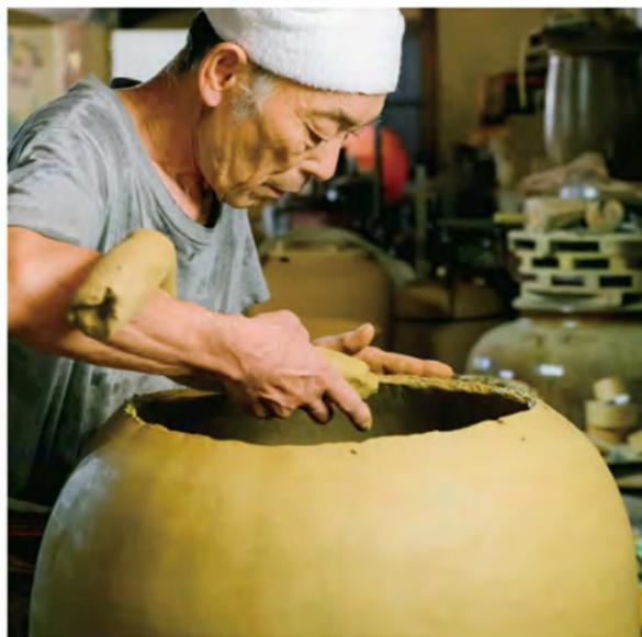
ヨリコ造りは、粘土を一気に積み上げるとその重みで潰れるため、一段積んで崩れない程度まで乾燥させて、次の段を積み重ねる技法。
