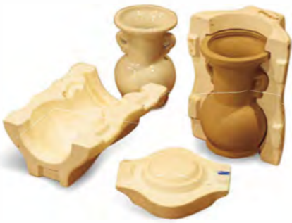
石膏型が水分を吸い取り、粘土が外側から固まるため、中身を取り出せば袋状の器ができあがる。
