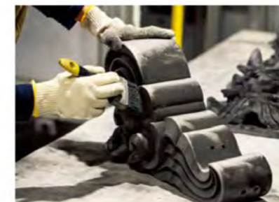
焼成は1,100°Cの窯でまる1日。いぶし加工によって表面に付着した煤(すす)を払って完成。
