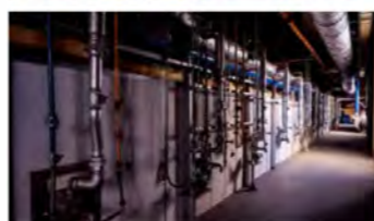
長さ約100mのトンネル窯で10時間かけて焼成。斜めに立て掛けることで歪みが防げる。
