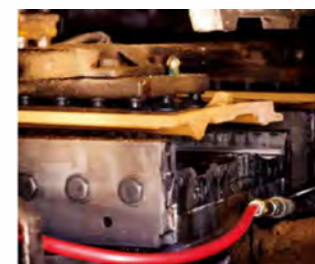
成形の工程。サイズを合わせた板状の粘土を金型でプレスし、瓦の形状にする。
