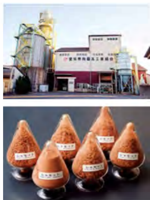
組合で運営するシャモット工場。パウダー状から直径20mmまで、用途別の粒度で破碎する。
