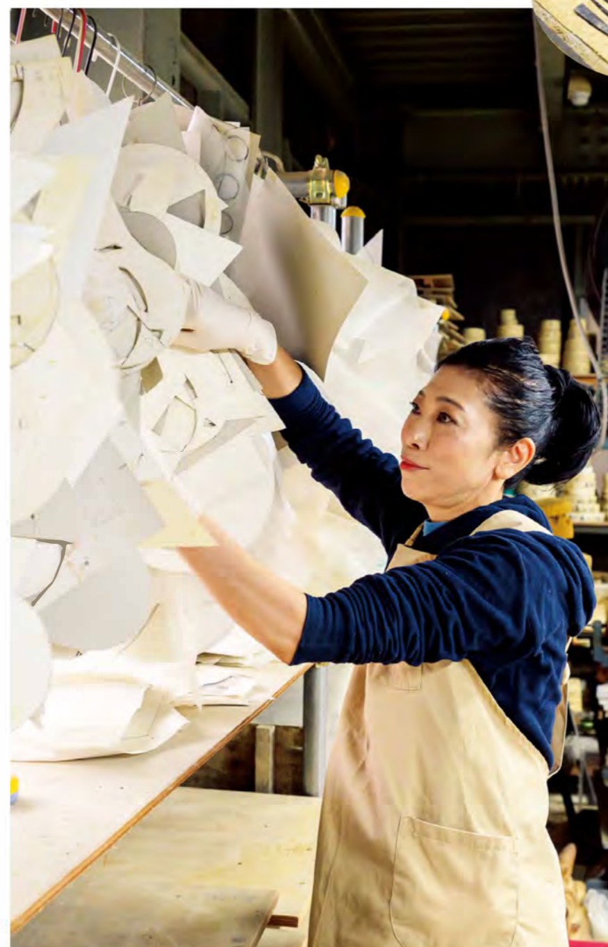
工房には、これまでに製作した鬼瓦の型紙がずらり。焼き縮みを計算して1割ほど大きめに作られている。
