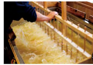
紙の原料と練りを混ぜ、原料を一本一本分離させる攪拌(かくはん)の工程。
