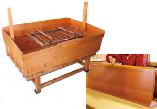
「本美濃紙」作りに欠かせない「すき舟」や「笥桁(すけた)」、「刷毛」。こうした伝統的な道具の作り手も減っているという。
