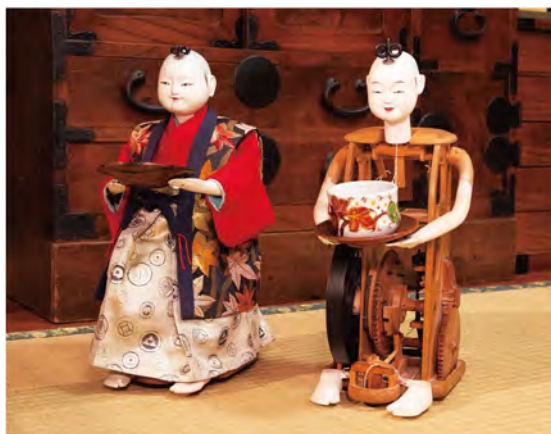
「茶運び人形」とその骨組み。窓車の仕組みは、モノづくりの原点になっています。
