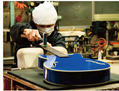
手作業で生み出されるアコースティックギター。写真は、フレットを打ち込んでいる工程。
