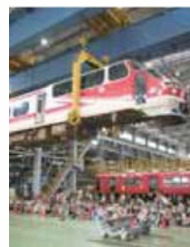
36トンクレーン作業実演
