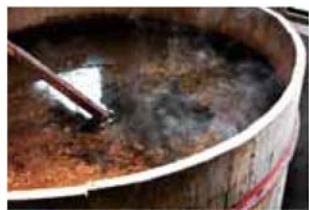
原料の炊き込みは一日がかり。温度の管理、焦げ付かないようこまめにかくはんするなど、非常に手間のかかる作業です。
