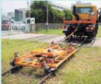
レール・枕木・道床のズレやゆがみを測定します。測定により得られたデータに基づきマルチプルタイタンパーの作業箇所を特定するなど、保線業務に活用しています。従来は手作業でレールのゆがみを測定していましたが、作業の正確性・効率性の向上のために平成12年9月に導入しました。現在、1両所有しており、約1年をかけて全線を回ります。
