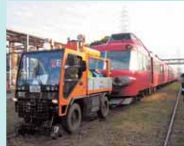
当社では事故や災害などの際に速やかに保線業務が行えるように、様々な多目的作業車を所有しています。その中には、「事故車両・故障車両の牽引」、「資材搬入」、「保守用車両の牽引」、「高所作業」など一両で何役もこなす事ができる車両(上記写真)もあり、平成16年4月から採用しています。なお、この多目的作業車は線路と道路の両方で走行することができる汎用性の高い車両です。
