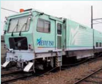
レールと枕木の下には砕石が敷き詰められています(これを道床といいます)。マルチプルタイタンパーは、枕木と枕木の間につき固め部分を挿入して振動を与えながら道床をつき固めるとともに、レールの位置を正規の状態に修正し、安全で安定した軌道を維持しています。現在、小型のものも含めて計10両所有しています。なお、環境へも配慮し防音対策を施しています。
