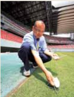
1日3回、水分計で土中の水分を計測し、芝にまく水の量を決めます
