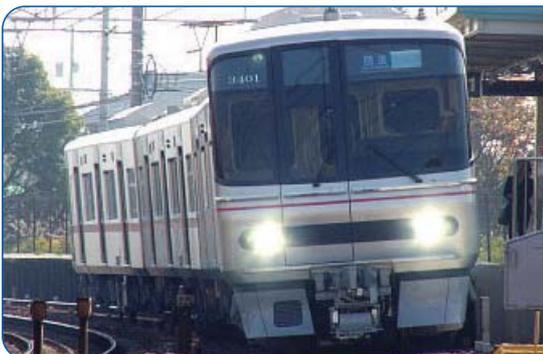
通勤車の代替として平成16年にデビュー。3300系（4両組成）と3150系（2両組成）は名古屋本線系を運用する車両として、はじめてステンレス車体を採用しました。平成14年にデビューした300系の機器をベースに設計した車両情報管理装置（TICS）搭載車で、既存の電気指令ブレーキ車と併結を可能にするため、伝送指令を変換する読替装置を搭載しています。また、片側3扉、座席はロングシートと転換クロスシートの組み合わせとし、車椅子スペースには跳ね上げ式の補助腰掛を設置しています。名鉄カラーのスカークラッシュの3500系などと併結運転されることがあり、ステンレス車体が一際目立つ存在となっています。
