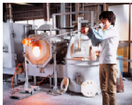
1160℃の高温で熱したガラスを吹いて、成形していきます
