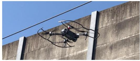
対角寸法約 360mm・重量約1kgのコンパクトな機体です。サーマル(赤外線)カメラも搭載しており、可視画像と併せて確認することで、コンクリートの浮き等の検出精度を高めます。
