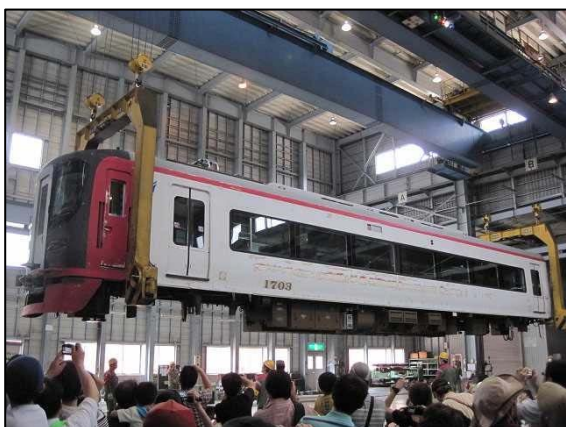
電車つり上げ作業
