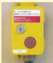
列車非常通報ボタン
