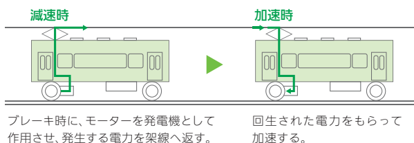
■電力回生ブレーキシステムの仕組み
