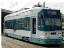
豊橋市内と渥美半島に鉄軌道路線を持つ豊橋鉄道では、市内線(路面電車)に「低床式車両」をはじめ導入しました。停留所の床面から車両までの段差は、従来車に比べ約35cm改善され、
