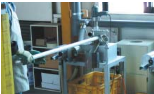
蛍光管のリサイクル(口金の取外し)作業
