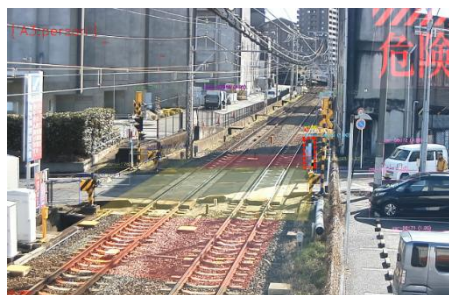
AI 画像解析装置により物体を検知している様子 (イメージ)
