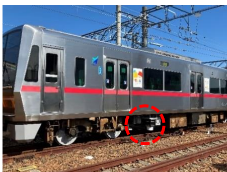
軌道変位モニタリング装置搭載状況
