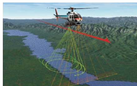
ヘリコプターによるレーザー測量イメージ
