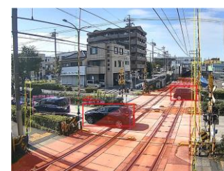
AI画像解析装置による踏切での物体検知の様子(イメージ)
